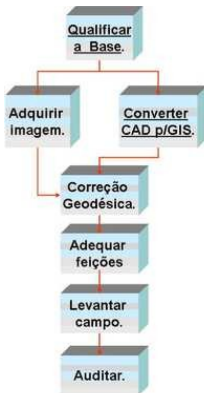
Figura 8 – Fluxo do processo de conversão baseado em correção geodésica.
