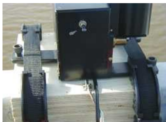
Figura 14: Vista do acelerômetro fixado no suporte de madeira
