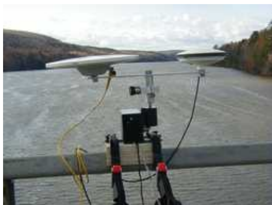
Figura 13: Suporte de madeira com oscilador, prisma e antenas GPS fixados no guarda-corpo
