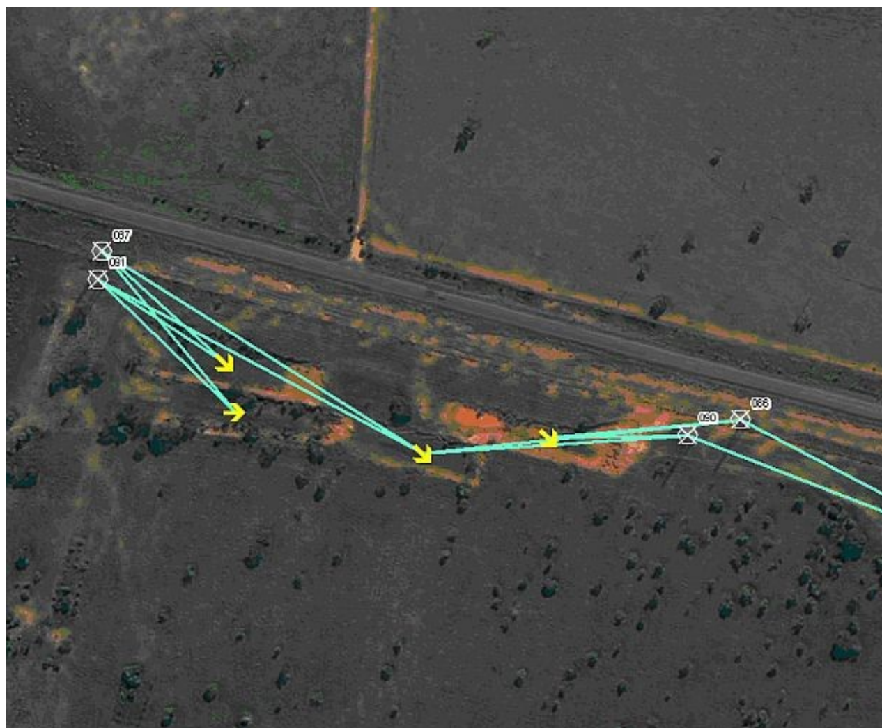
Figura 7 : Alinhamento das feições erosivas com as torres (linhas verdes) e direção de recuo da erosão (setas amarelas).
