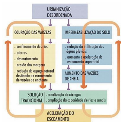
Figura 3 : Processo de impacto da urbanização na drenagem (adaptado de Sudersha, 2002)
