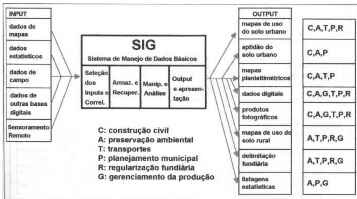
Figura 3: Estrutura de um SIG (Loch, 1998; Itokazu et al 2000)
