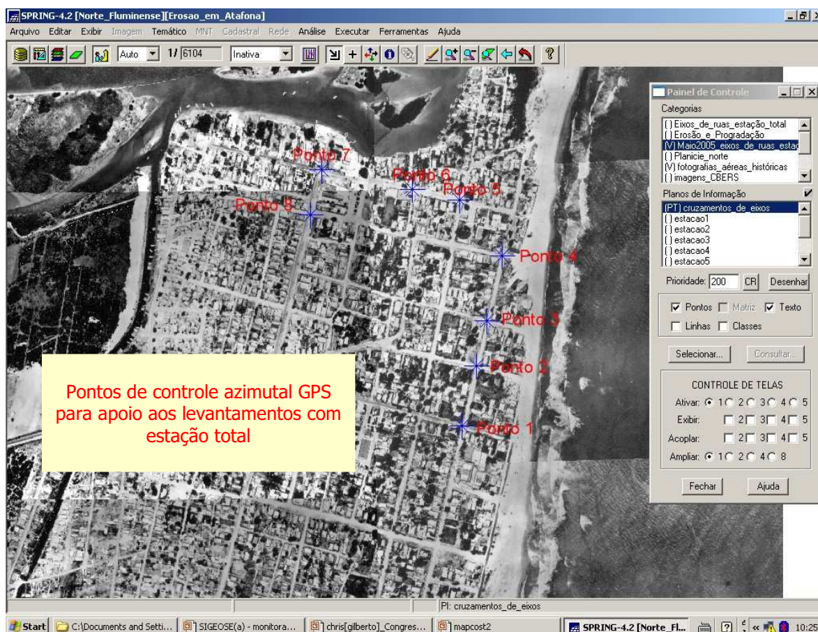
Figura 14: pontos GPS para controle azimuthal dos levantamentos geodésicos com estação total.
