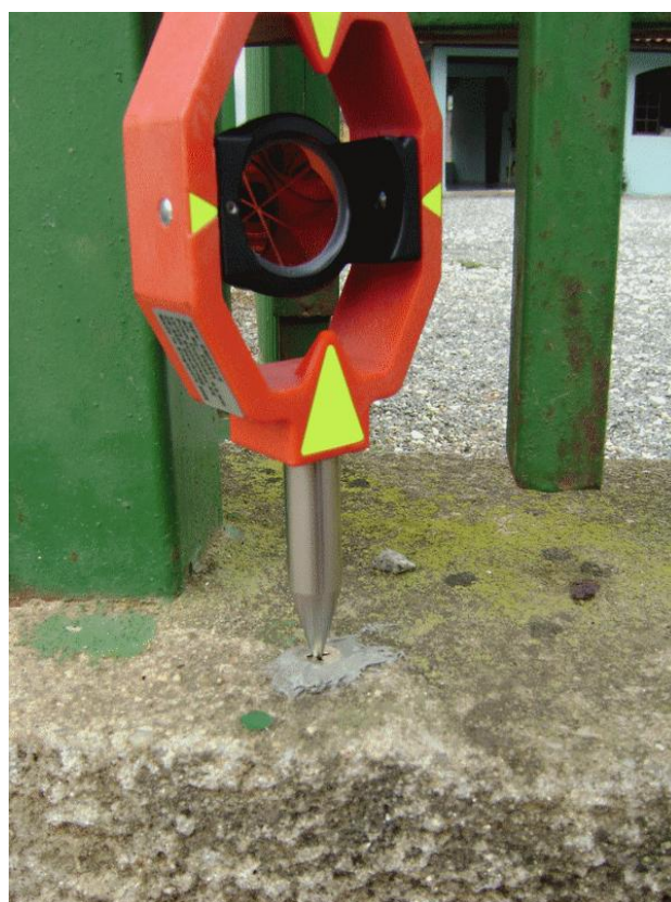
Figura 3 : Ponto de controle engastado em estrutura física
