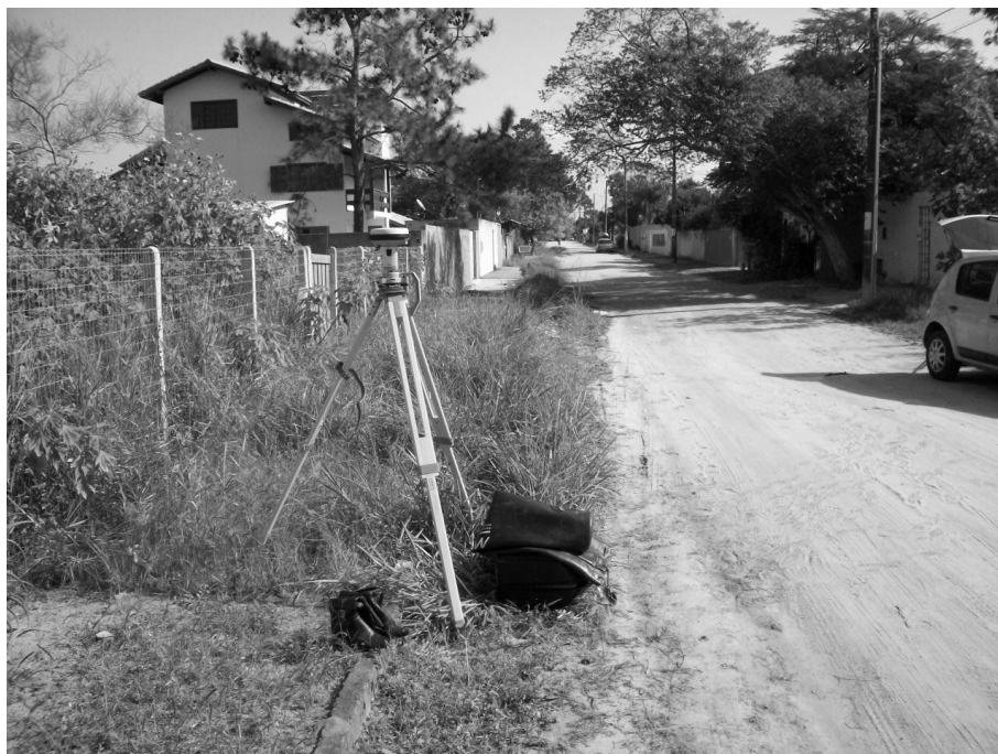
Figura 4 : Receptor GNSS rastreando o ponto de apoio
