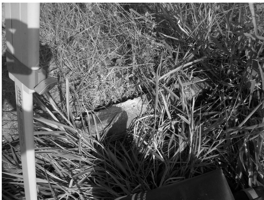
Figura 3 : Ponto de apoio demarcado com pino metálico
