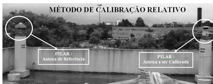
Figura 2 – Calibração Relativa em Campo (HUINCA E KRUEGER, 2011).
