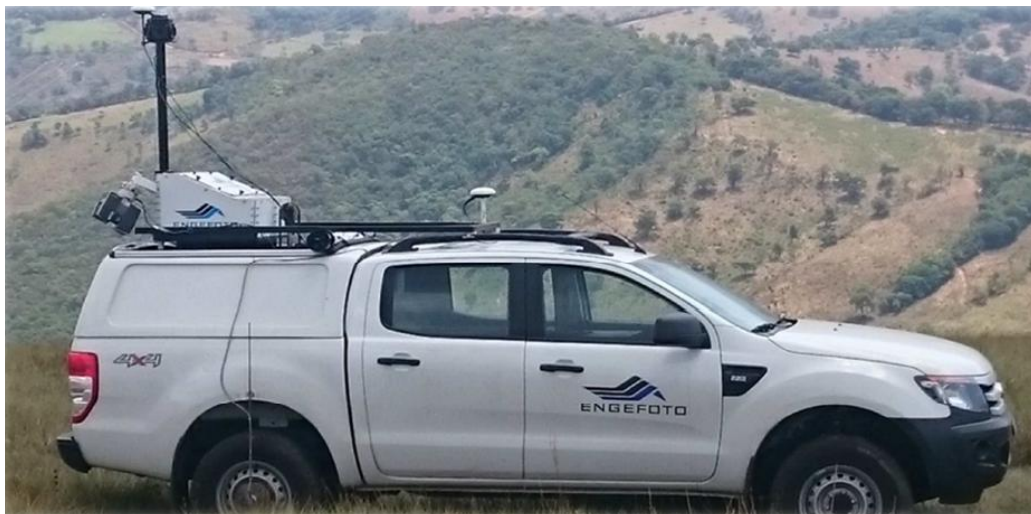
Figura 3: Sistema de Escaneamento LASER Móvel (MMS-Engefoto) Fonte: Engefoto S/A.
