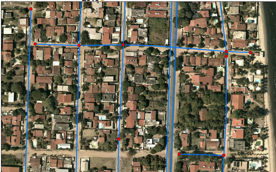
Figura 5 – Imagem com a vetorização da rede. Fonte: adaptado da base cartográfica da COMPESA.
