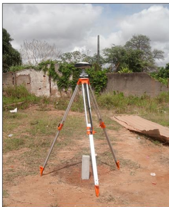
Figura 02: Receptor GNSS L1/L2 – FOIF A20 – rastreamento de Marco na área de exploração Cerâmica Arapiraca.
