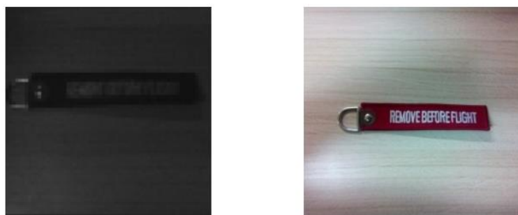
Figura 5 – Comparação entre a imagem adquirida pela câmera da PX4FLOW e uma câmera comercial de 8 MP.
