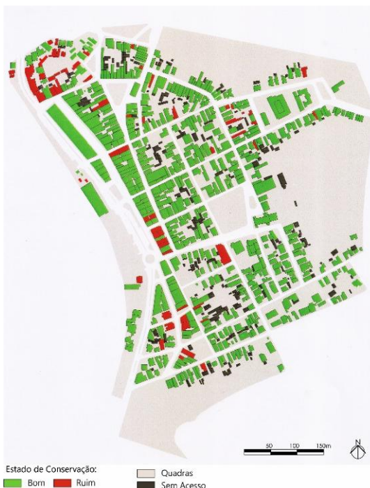
Figura 2 – Estado de conservação das edificações da poligonal de tombamento de Laguna, SC. Fonte: Elaborado pelos autores.
