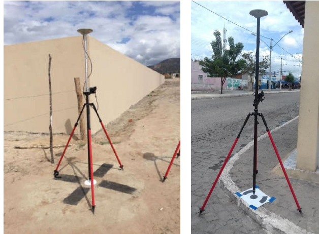
Figura 6 – Levantamento GNSS de pontos de controle pré-sinalizados, testando modelos de alvo
