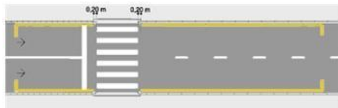
Figura 6 - estacionamento proibido nesta área. Fonte: Site Trânsito ideal.
