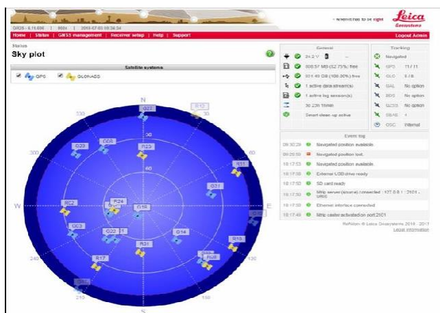
Figura 3: Tela de configuração e almanaque de satélites da estação de referência GR25.
