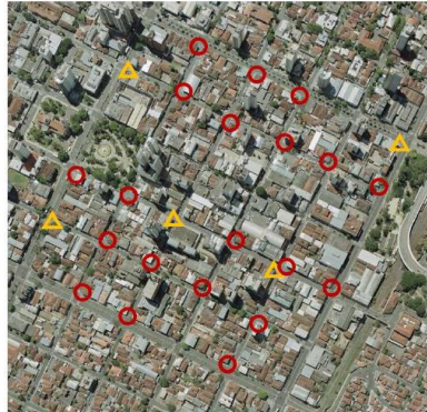
Figura 1 – Imagem utilizada com a posição espacial dos pontos de apoio e verificação.
