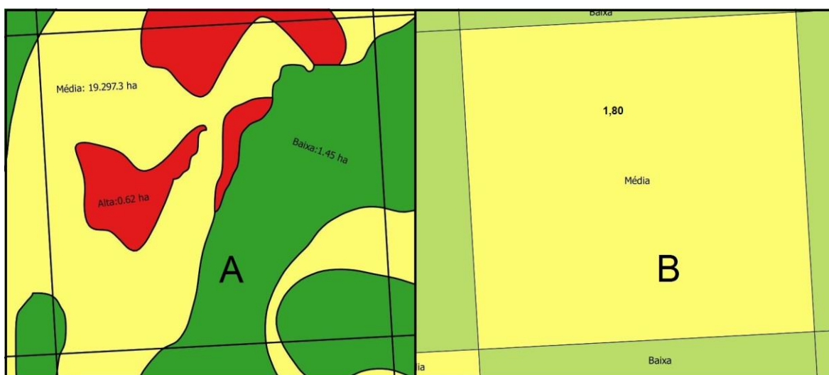
Figura 5 - Célula da grade com dados de suscetibilidade ao movimento de massa com as respectivas áreas (A) e a célula generalizada para a classe com maior área (Média) e a média ponderada (1,80) (B).
