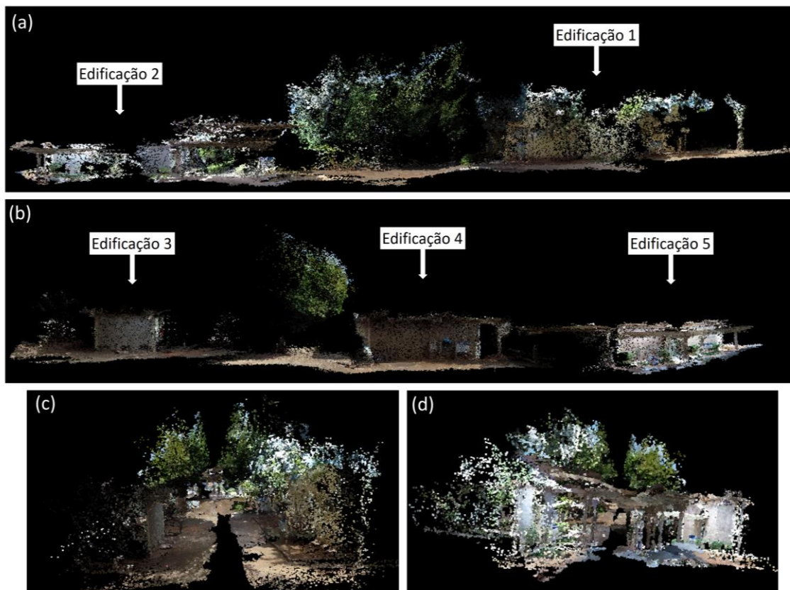
Figura 6 – Nuvem densa gerada do (a) sensor 1 e (b) sensor 2 e, (c) e (d) diferentes pontos de vista das duas nuvens no modelo 3D.
