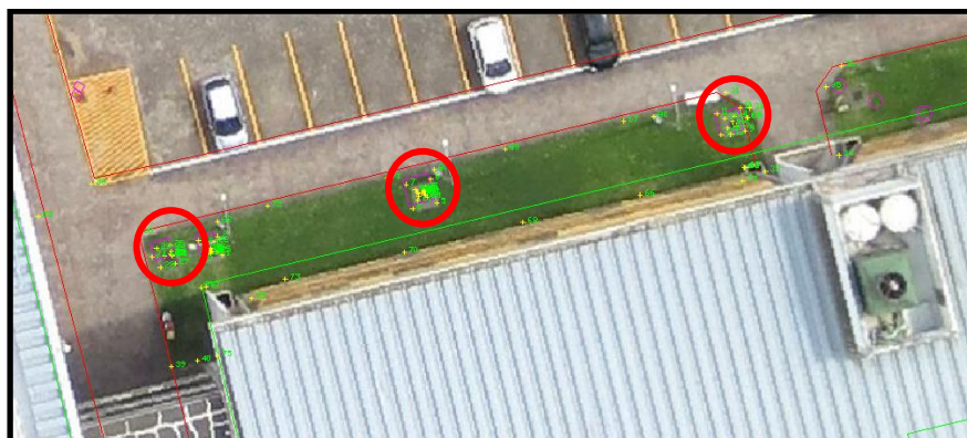
Figura 6 – Pontos obtidos da Estação Total e importados no software AutoCad Map 3D Fonte: Autores
