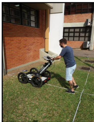
Figura 5 – Aquisição das seções geofísicas, alinhadas com trenas, para passagem do equipamento GPR Fonte: Autores
