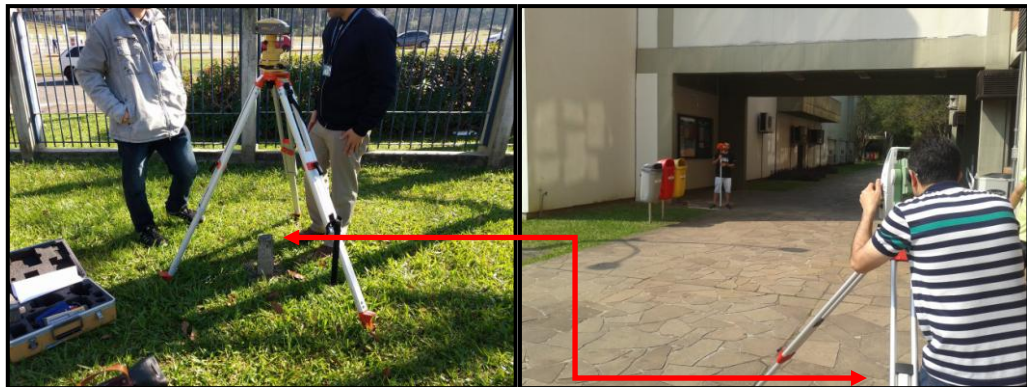
Figura 2 – Transporte de coordenadas do marco M02 para um ponto próximo da área de estudo
