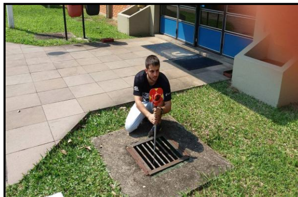
Figura 3 – Levantamento cadastral da tubulação com estação total
