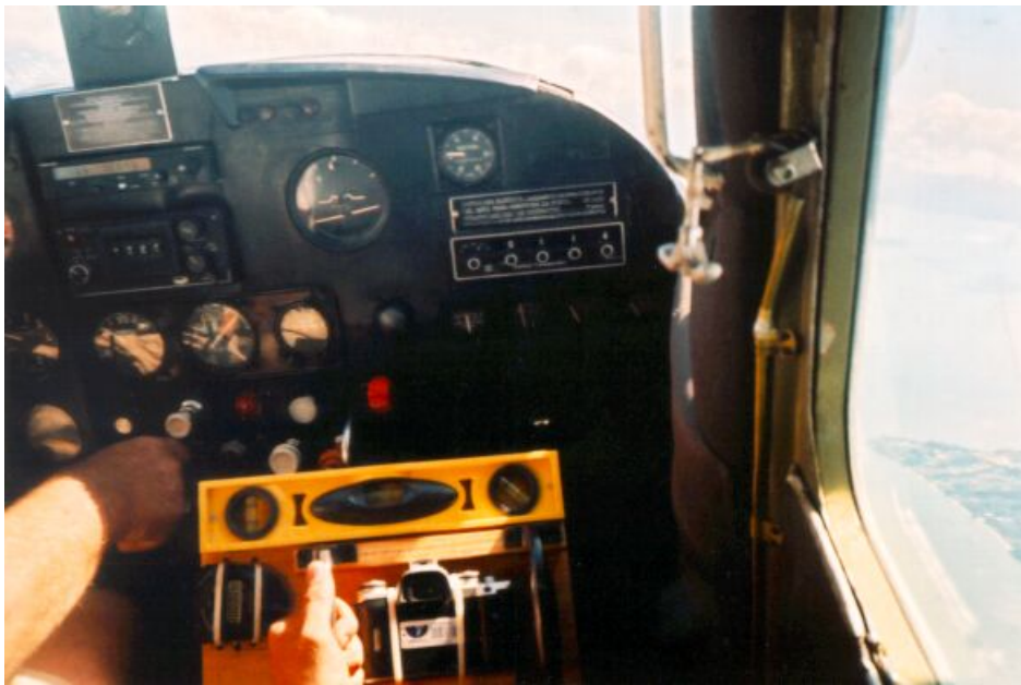
Figura 6 : Base para câmara fotográfica e painel da aeronave
