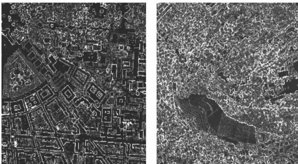
Figura 6: Imagens contendo os valores de curvatura calculados para o primeiro nível da pirâmide.
