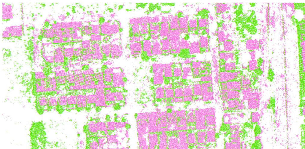
Figura 11 – Resultado da classificação após a junção das classes Telhado de zinco e Telhado de barro.
