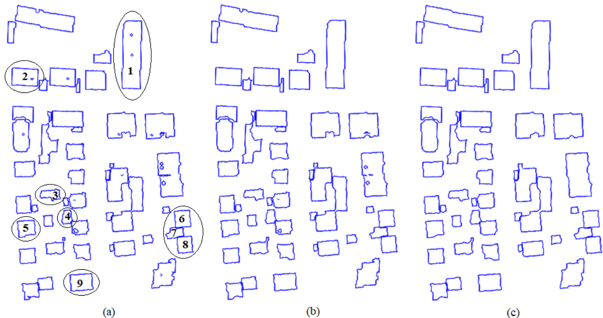
Figura 6 – Contornos de edificações obtidos usando \alpha = k s_{avg} , para diferentes valores de k. (a) k = 1,25 ; (b) k = 1,5 ; e (c) k = 2 .
