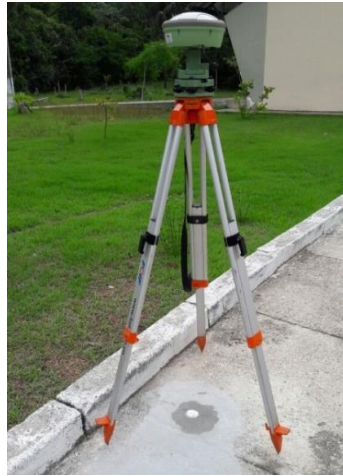
Figura 8 – Receptor GNSS no momento do rastreamento na Estação M003, implantada em superfície estável no Campus da UFPA.
