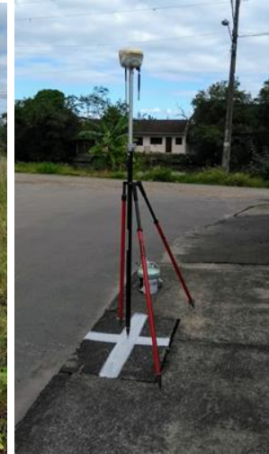
Figura 1 – Phantom 4 Pro utilizado no levantamento aéreo (a) e levantamento do PCT com equipamento GNSS (b)
