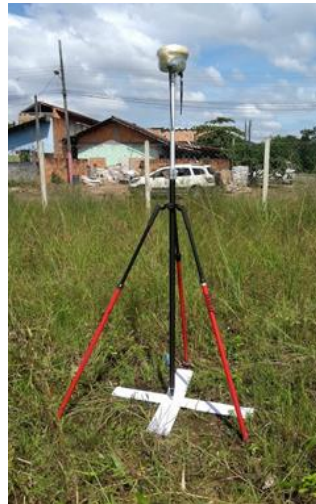
Figura 1 – Phantom 4 Pro utilizado no levantamento aéreo (a) e levantamento do PCT com equipamento GNSS (b)
