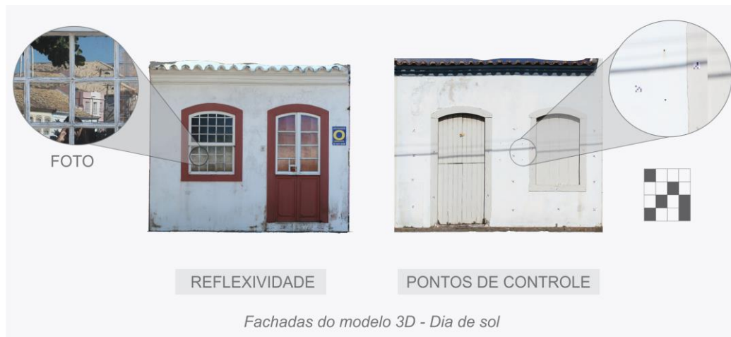
Figura 10– Fachadas com a correção da reflexividade e o uso de pontos de controle.
