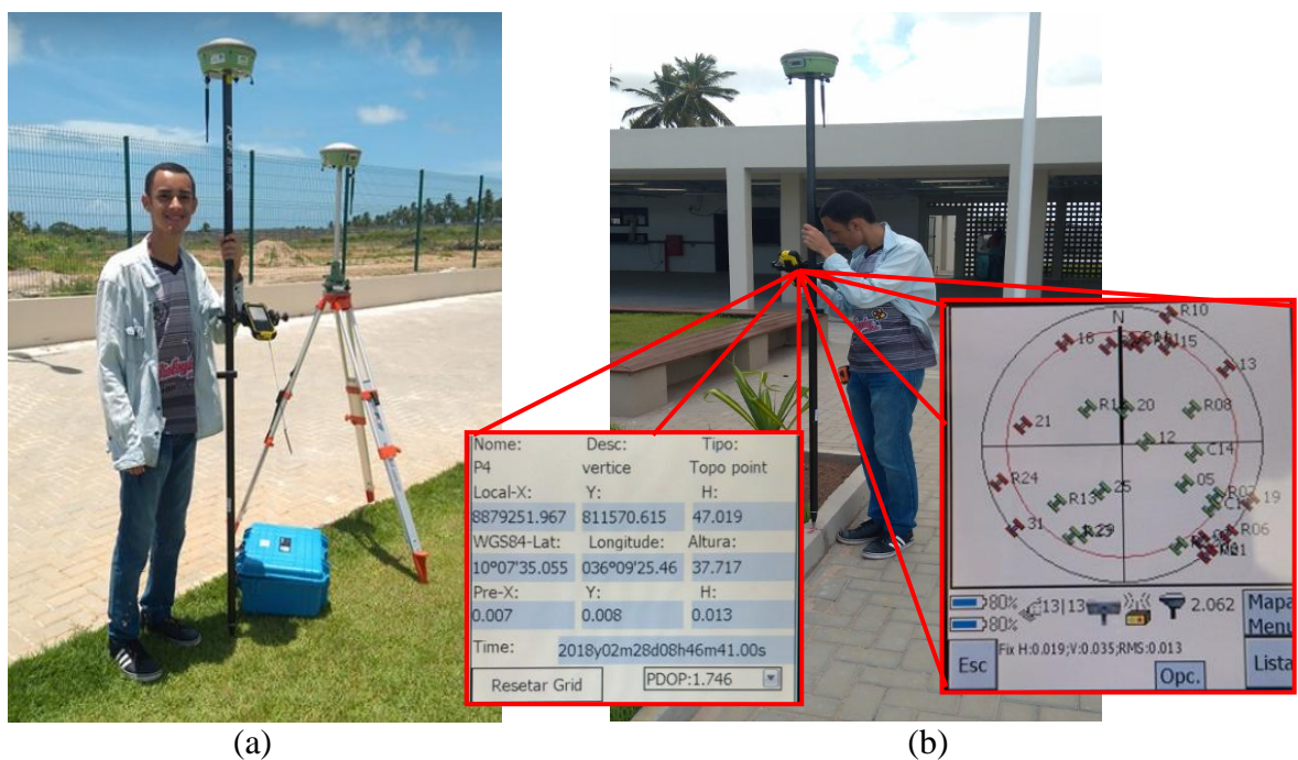
Figura 3 – Levantamento GNSS RTK: (a) Receptores base e rover; (b) Rastreamento do ponto P4
