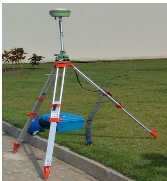
Figura 2 – Levantamento GNSS da estação base
