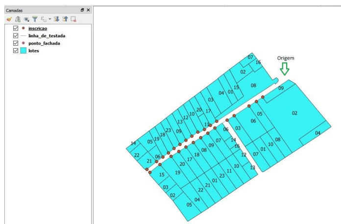
Figura 9 - composição dos lotes das quadras 121, 125 e 120, dos pontos, e das linhas de testada
