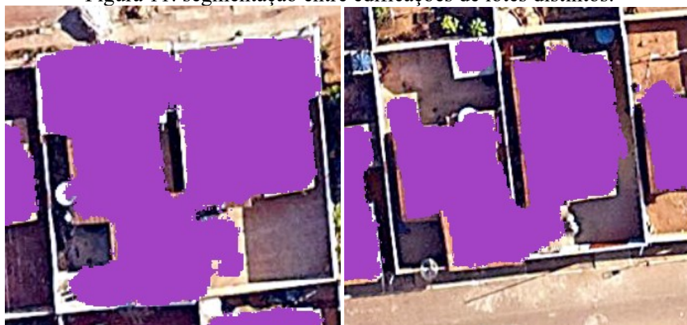
Figura 11: segmentação entre edificações de lotes distintos.
