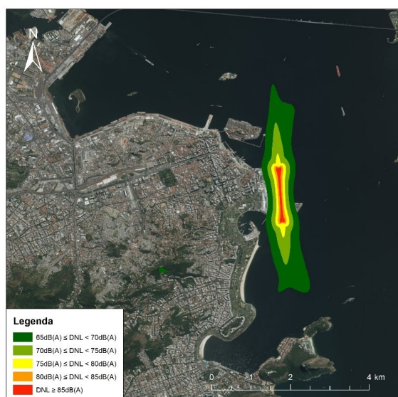
Figura 3 - Curva de ruído na métrica DNL rota antiga para o SDU
