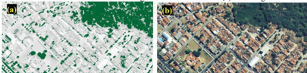
Figura 6 – Resultado da extração da área verde urbana em Floresta - PE. (a) Superposição da área verde extraída sem sombra e a imagem em níveis de cinza. (b) Ortoimagem estudada
