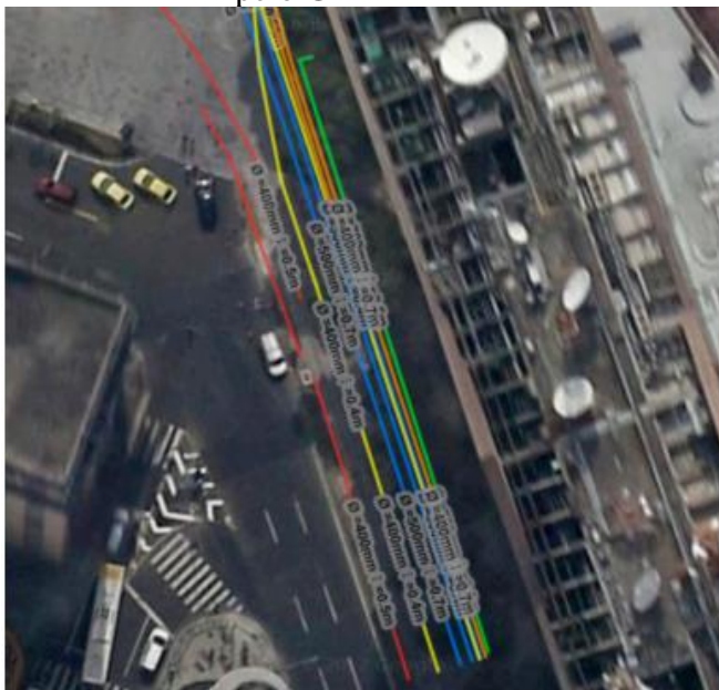
Figura 6. Exemplo de aglomeração de infraestruturas na mesma avenida detectada pelo GPR
