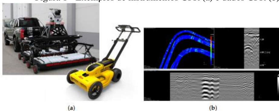
Figura 1 - Exemplos de instrumentos GPR (a) e dados GPR (b).
