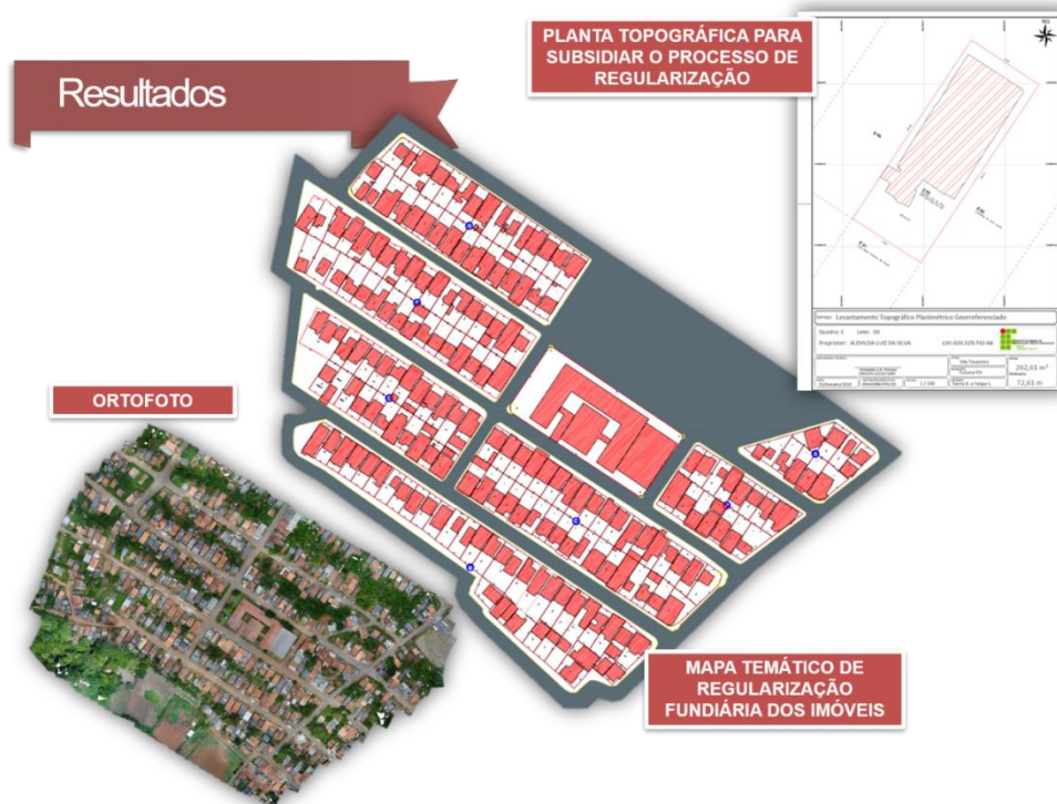
Figura 8. a) Ortomosaico obtido após o processamento das 676 imagens do aerolevanteamento; b) Mapa Temático referente à Área dos Imóveis, das Quadras e do Perímetro da Vila Tocantins; e c) Plantas Topográficas dos lotes.
