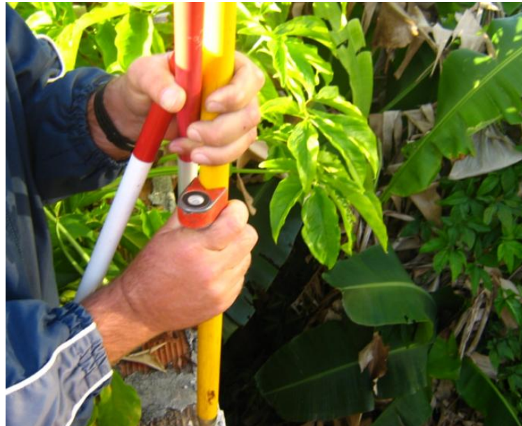
Figura 6 – Vértice V3 materializado no muro sendo levantado.
