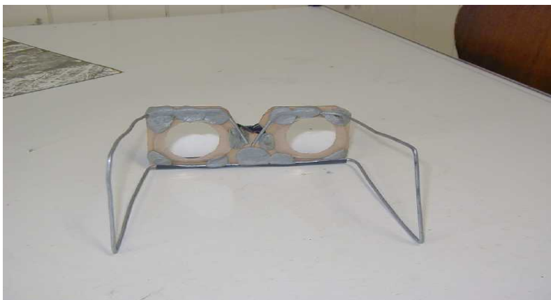
Figura 13 : Estereoscópio rudimentar construído artesanalmente
