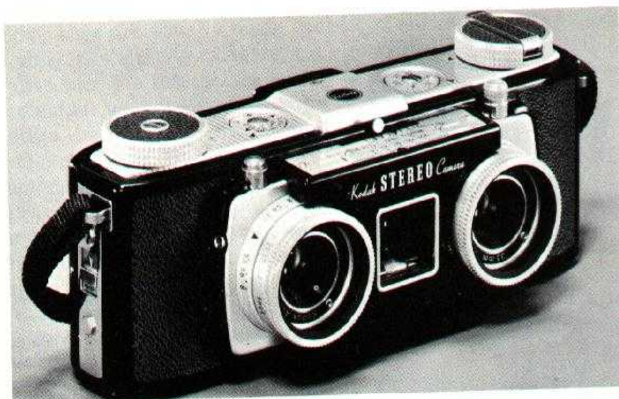
Figura 5 : Câmera com dois visores para obtenção de pares estereoscópicos, fabricada no início do século XX
