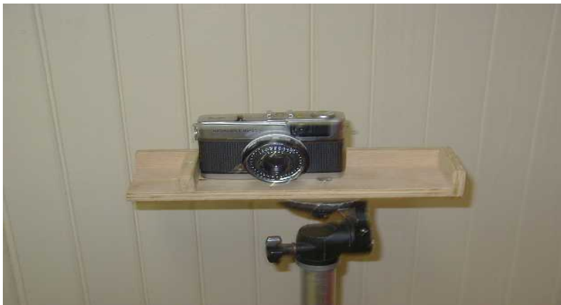
Figura 12: Base para tomada de pares estereoscópios.
