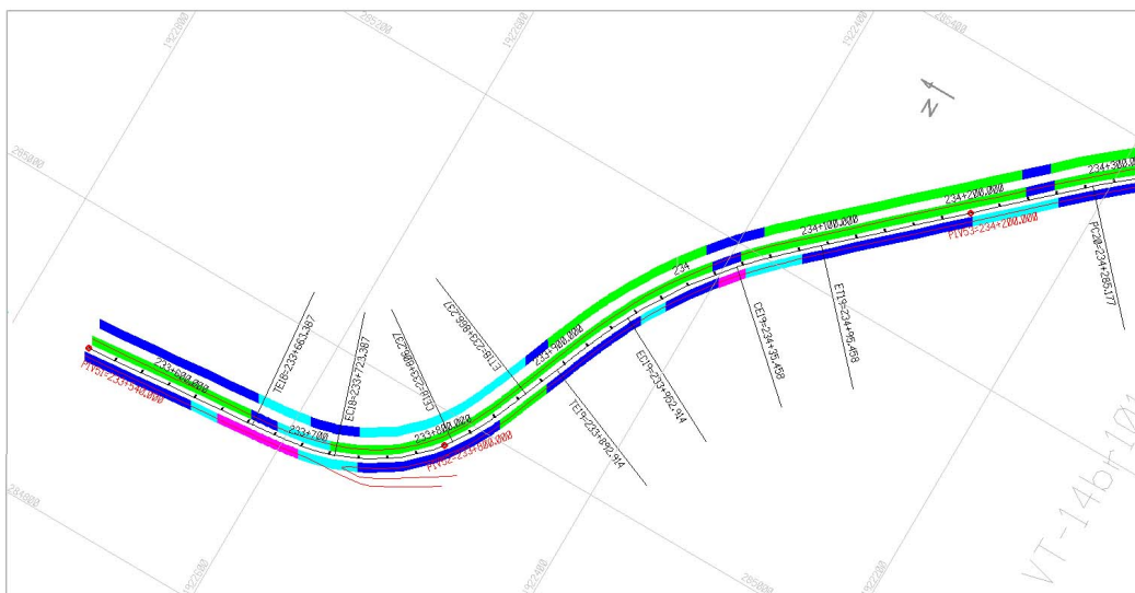
Fig. 4.4.2. : Detalhe da Qualidade da Superfície por Faixa de Tráfego
