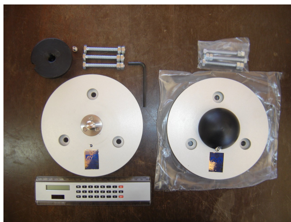
Figura 4 – Base de Centragem Forçada
