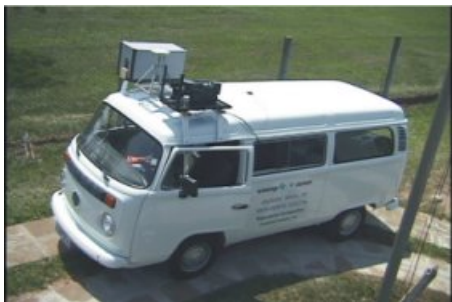
Fig. 1: Unidade Móvel de Mapeamento Digital, com câmaras de vídeo digitais e antenas GPS
