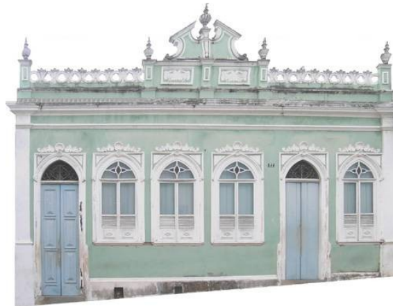
Figura 8 - Foto retificada obtida a partir de fotografias tiradas de ângulos diferentes
