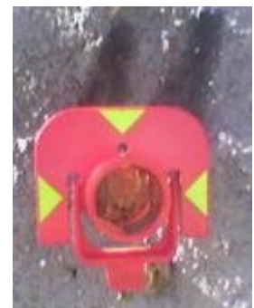
Figura 3: Prisma utilizado posicionado em um ponto de controle sobre o muro
