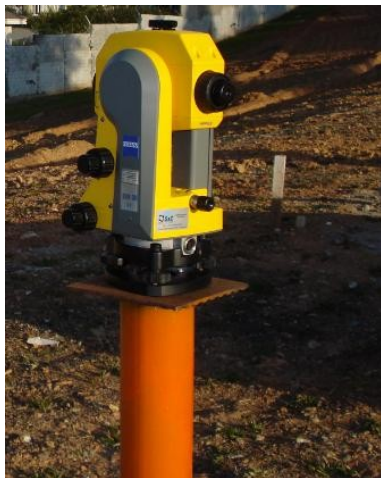
Figura 2: Estação total e base de centragem forçada utilizada no local do monitoramento
