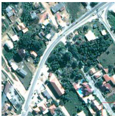
Figura 5 : Composição Colorida, bandas 1, 2 e 3 (RGB), sensor QuickBird.
