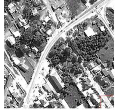
Figura 3 : Banda 3 do sensor QuickBird, faixa espectral do visível (630 - 690 nm)
