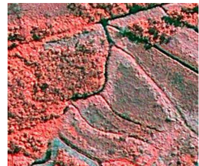
Figura 6 : Composição Colorida, bandas 4, 3 e 2 (RGB) sensor QuickBird.
