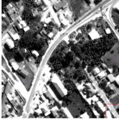
Figura 1 : Banda 1 do sensor QuickBird, faixa espectral do visível (450 - 520 nm)
