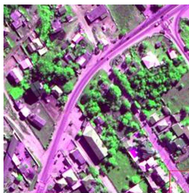
Figura 7 : Composição Colorida, bandas 4, 3 e 2 (GBR), sensor QuickBird.
