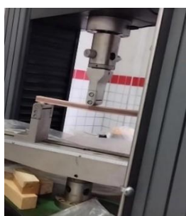
Figura 1 - Ensaio de flexão estática em máquina universal de ensaios mecânicos.
