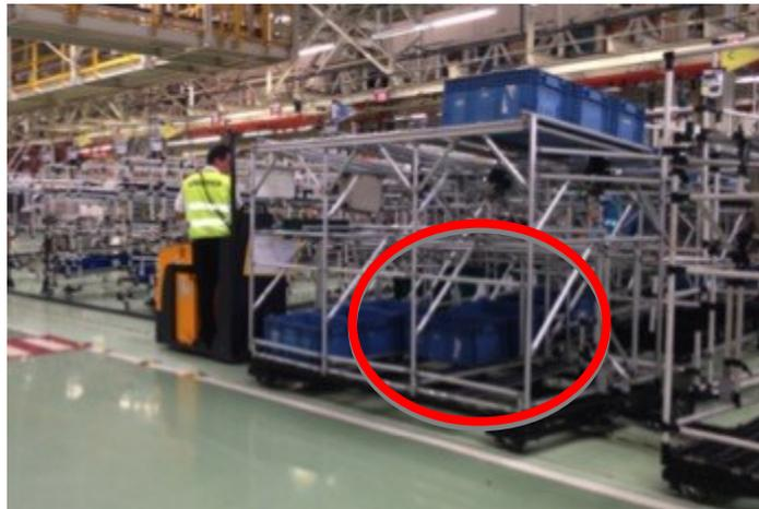
Figura 9 – Embalagens do coletor emperrando ao voltar para o veículo
